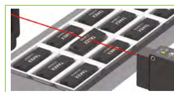
Controllo della posizione corretta dei componenti in un vassoio
