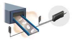
Rilevare polvere o sporco sulla parte attiva monitorando l'intensità della luce ricevuta e avvisando se questa diminuisce.
