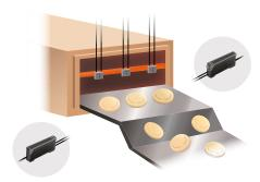
Rilevare disturbi luminosi indesiderati monitorando l'intensità della luce ricevuta e avvisando se questa aumenta a causa di riflessi provocati da vapore o condensa.
