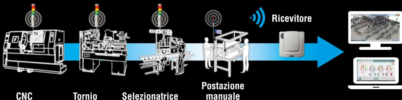
Trasforma una torretta di segnalazione in una sorgente di dati utili per la gestione dell'efficienza di macchine ed impianti
