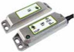
Profilo stretto per montaggio ad incasso. Può essere montato facilmente. Finitura lucida. 88mm di lunghezza x 25mm di larghezza. Sensibilità codificata dell'interruttore: 14mm. Sensibilità magnetica interruttore: 12mm. Adatto per schizzi di cibo.
