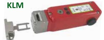
Interruttore di metallo pressofuso adatto a blocchi per controlli pesanti con blocco al solenoide. Fornisce 4 contatti NC di sicurezza e 2 contatti NO ausiliari o LED di indicazione diagnostica. I 3 ingressi per il cavo e i 30mm di fissaggio permettono la massima flessibilità in tutte le applicazioni. 46mm x 176mm e 30mm di fissaggio.
