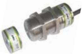
Custodia cilindrica con filettatura M30. Lungo 45mm. Facile da installare e da configurare. Adatto per tutte le applicazioni. Sensibilità codificata dell'interruttore: 10mm. Sensibilità magnetica interruttore: 10mm. Adatto per zone a contatto con gli alimenti.
