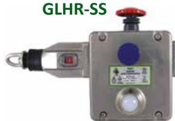
Gli interruttori della Guardian Line in acciaio inox 316 sono stati progettati come sistema di interruttore a fune per servizio pesante per proteggere convogliatori lunghi fino a 250m con un solo interruttore. Possono essere coperte distanze fino a 5 km collegando assieme più interruttori. I fori di fissaggio sono sotto la copertura dell'interruttore per evitare zone di accumulo e contaminazione di residui alimentari. Sono disponibili anche le versioni ATEX.
