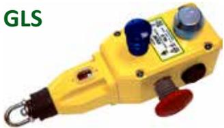
Progettato per un servizio normale, il modello GLS è in grado di proteggere nastri trasportatori fino ad una lunghezza di 80m (utilizzando due interruttori) o fino a 60m con un singolo interruttore. Sono forniti completi di pulsante d'emergenza a fungo che, senza collegamenti esterni, si fissa al lato dell'interruttore offrendo un comando d'emergenza aggiuntivo. E' disponibile la versione adatta ad aree con pericolo d'esplosione (ATEX).
