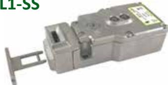
Solenoido di bloccaggio. Disponibili 4 punti di entrata per l'attuatore. Testa girevole. Compatto 63x143mm. 2 contatti di controllo del dispositivo di bloccaggio. LED 1: stato del solenoide sotto tensione LED 2: stato dell'interblocco
