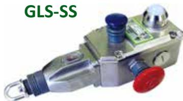
Il GLS-SS è un interruttore in acciaio inox a fune per uso standard sviluppato per proteggere nastri trasportatori lunghi fino a 100m. I fori di fissaggio sono sotto il coperchio dell'interruttore per evitare qualsiasi contaminazione. LED bicolore per l'indicazione dello stato dell'interruttore.
