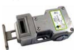
Fissaggio universale. Adatto alla maggior parte delle applicazioni. 52x99mm. Blocchi di contatto sostituibili. Testa girevole per 4 ingressi per l'attuatore. Attuatore standard o flessibile.
