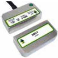
Piccola custodia igienica in acciaio inossidabile 316. Fori di fissaggio posteriori, per evitare contaminazioni alimentari. Compatta solo 50mm di lunghezza e interasse di fissaggio di 22mm. Sensibilità codificata dell'interruttore: 14mm. Sensibilità magnetica interruttore: 12mm. Adatto per zone a contatto con gli alimenti.
