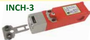
Disponibili 8 posizioni di ingresso per l'attuatore, testa girevole in acciaio inox. 3 contatti di blocco. Scelta di tre ingressi cavo. Custodia in plastica con protezione IP67. 25mm x 79mm e 22mm di fissaggio.
