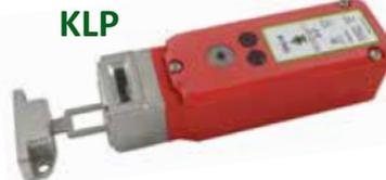
Custodia in plastica/testa in acciaio inox e interruttore di blocco per controlli medi e pesanti. Fornisce 2 contatti di sicurezza NC e 2 contatti ausiliari NO o LED di indicazione diagnostica. 8 posizioni di ingresso per l'attuatore, testa girevole. Blocco al solenoide. 46mm x 160mm e 30mm di fissaggio.
