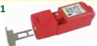
Compatto e robusto, adatto per tutte le piccole applicazioni di sicurezza. Adatto per l'industria di trasformazione alimentare e petrolchimici. Disponibili 8 posizioni di ingresso per l'attuatore, testa girevole. 3 contatti di blocco o 2 poli a scatto. 32mm x 97mm e 17mm di fissaggio.
